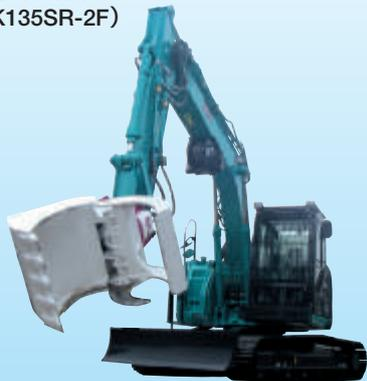
●格納式刃物付きグラップルバケットで、「掘る」「つかむ」「積込む」に加え、「伐倒」も可能です。
